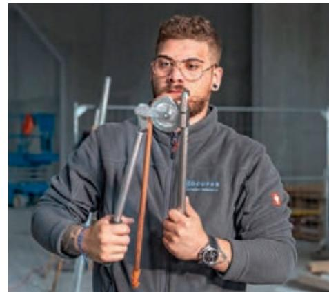
◀ Montage d'une installation Lors de l'installation de systèmes de réfrigération sur les chantiers, l'une des tâches les plus courantes consiste à couper et à plier les tuyaux en cuivre.
