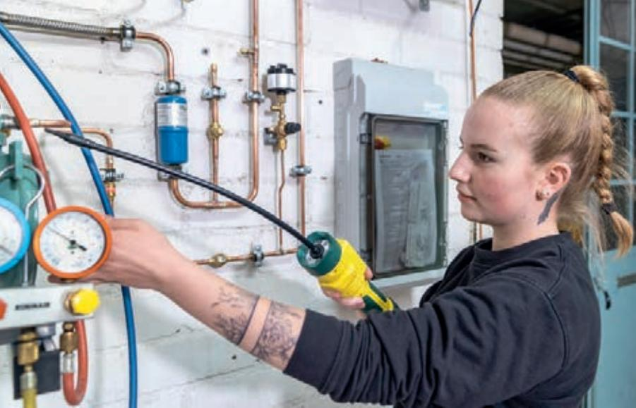
Le détecteur de fuite posé sur le joint de soudure se met à sonner en cas de problème d'étanchéité.
